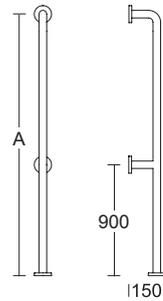
**Haltegriff zur vertikalen Boden-/Wandmontage mit Mittelstütze**
