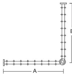
**Duschvorhangstange L-Form mit Deckenabhängung**
