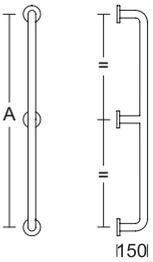
**Haltegriff zur vertikalen Wandmontage mit Mittelstütze**
