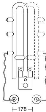
**Stützklappgriff drehbar mit doppel E-Taster**
