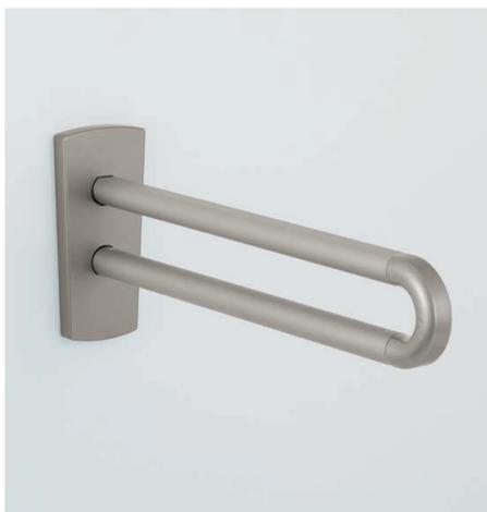
PBA Wandstützgriff aus Aluminium mit hochwertiger, pulverbeschichteter Oberfläche. Griffteil aus stranggepresstem Aluminiumrohr 36 mm x 35 mm, Rohrprofil eckig mit nach oben gerichteter Rundung. Wandbefestigung mit Wandplatte und Abdeckkappe aus Aluminium-Druckguss zur unsichtbaren Verschraubung. Maße der Abdeckkappe: Breite 112 mm, Höhe 248 mm. Befestigung mit 3 Befestigungsschrauben.
