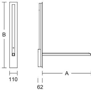
**Stützklappgriff, versenkbar für Wandeinbau**
