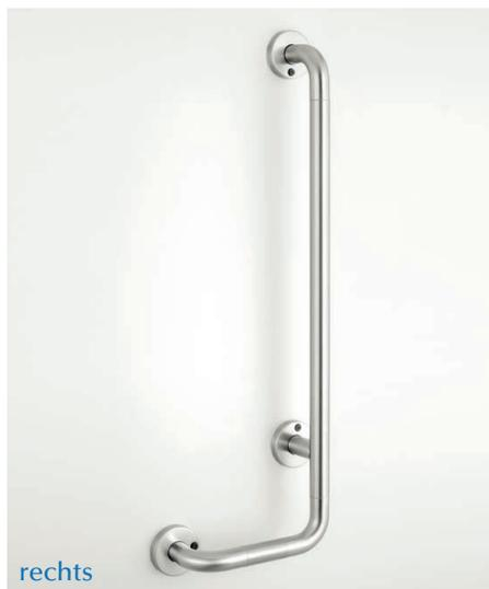
PBA Sicherheitsgriff, L-Form aus Edelstahl rostfrei, Werkstoff 1.4404 mit satiniertes Oberfläche. Griff bestehend aus Stahlrohr  $\varnothing$  32 mm x 1,5 mm. Rechts/links einsetzbar. Wandbefestigung mit Rosetten  $\varnothing$  80 mm bestehend aus korrosionsschutztem Stahlrosettenunterteil mit Abdeckkappe aus Edelstahl zur unsichtbaren Verschraubung.
