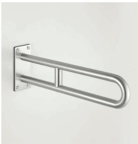
PBA Wandstützgriff, feststehend aus Edelstahl rostfrei, Werkstoff 1.4404 mit satinierte Oberfläche. Griff bestehend aus Stahlrohr  $\varnothing$  32 mm x 1,5 mm. Rohrenden einseitig mit 180° Endbogen verbunden. Wandbefestigung mit Wandplatte aus Edelstahl Breite 90 mm, Höhe 200 mm mit Wandauflage aus Nylon in Farbe anthrazit. Befestigung mit 4 Befestigungsschrauben.
