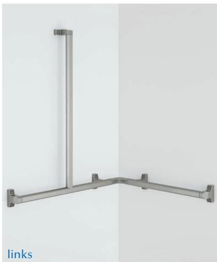
PBA Duschhandlauf mit Brausehalterstange, Handlauf bestehend aus profiliertem Aluminiumrohr mit eloxierter Oberfläche, nahtlos,  $\varnothing$  35/32 mm. Rechts/links einsetzbar. 2-Punkt Wandbefestigungen, bestehend aus Wandhalterung aus Zinkdruckguss, Oberfläche pulverbeschichtet, unsichtbare Verschraubung.
