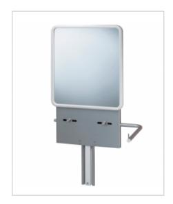
Manuell bis zu 270 mm höhenverstellbares Waschtischmodul mit Handbedienung. (System Gasdruck). Inklusive Spiegel 560x680 mm. Geeignet für Waschtische mit Bohrung von 180-370 mm, maximale Waschtischbreite 700 mm. Lieferung in Farbe weiss/alugrau, Gewicht 19 kg, 5 Jahre Garantie!
